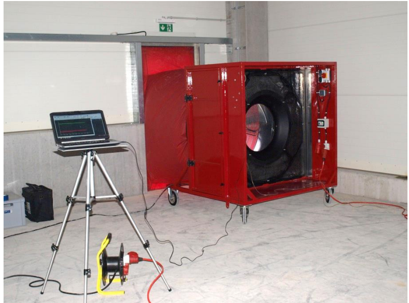
Messsystem EC-LME, Luftleistung bis 60.000 m 3 /h, entspricht etwa 8 BlowerDoor-Ventilatoren.
